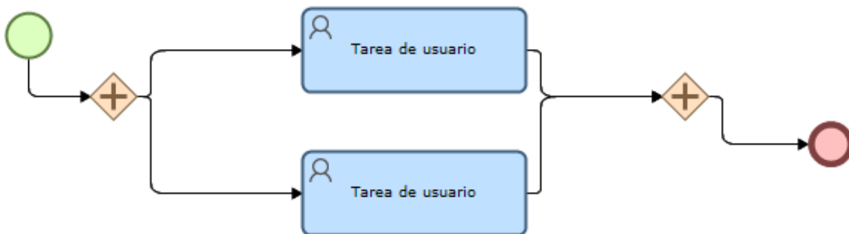
Figura 145 Template BPMN con par de compuertas paralelas
